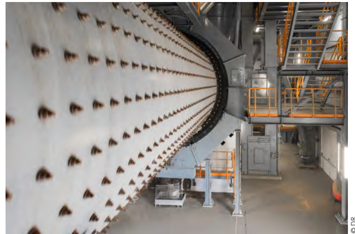
→ Un important broyeur de 4,4 m de diamètre assure un débit moyen de 80 t/h.
