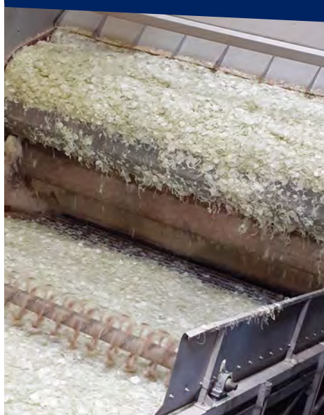
→ Les oignons sont tranchés en sortie du préchauffeur avant d'entrer dans le four.
